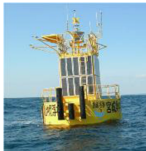
沿岸域での防災対策が期待されるGPS波浪計
