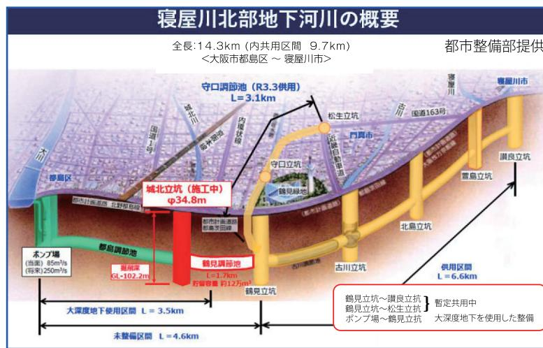
寝屋川市を通る寝屋川北部地下河川は、延長約14.3kmのうち鶴見立坑上流の約9.7kmが完成し、約26万m³の貯留容量を確保。今後、鶴見調節池の整備により、更に約12万m³の貯留容量が確保され、浸水被害軽減面積が約6,200ヘクタールに拡大します。
